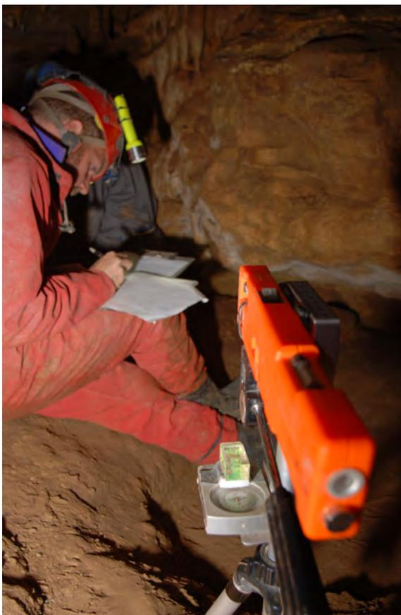
Fig. 7. Alineación con láser de brújula y clinómetro montado sobre un pequeño trípode para optimizar la toma de datos topográficos. Fotografía: José Martínez Hernández.
