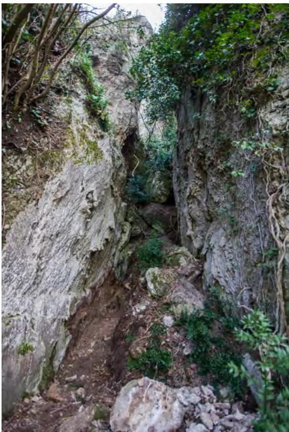
Fig. 3. Corridoio artificiale prodotto a seguito dell'estrazione di alcune vene di *lapis* nei pressi della cava a cielo aperto ubicata nel versante N di Monte Mauro (foto P. Lucci).
