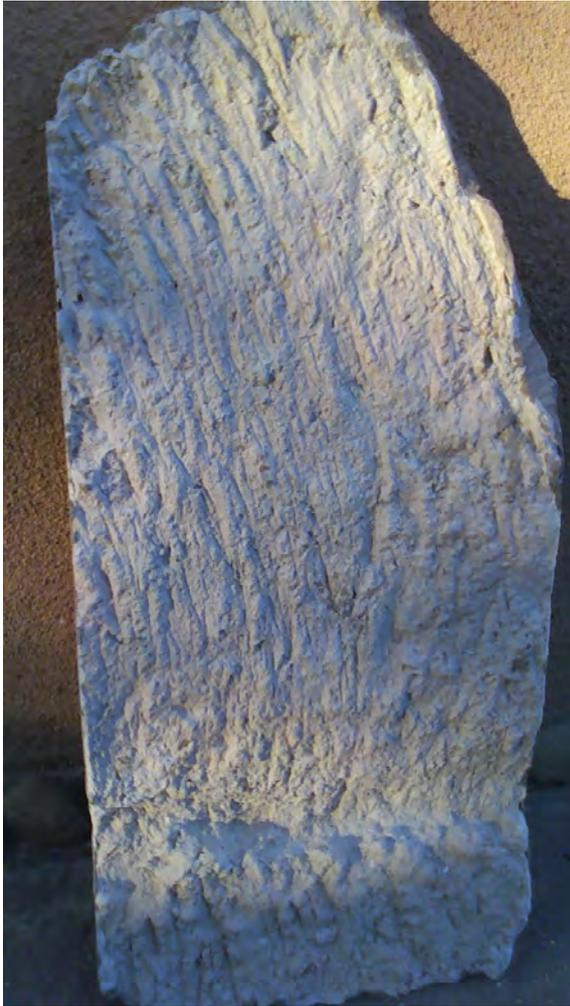
Fig. 5. Calco di una parete della Cava della Lucerna con scalpellature.
